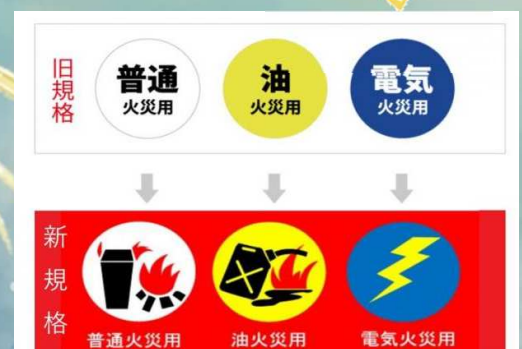
新旧適応火災表示マーク
