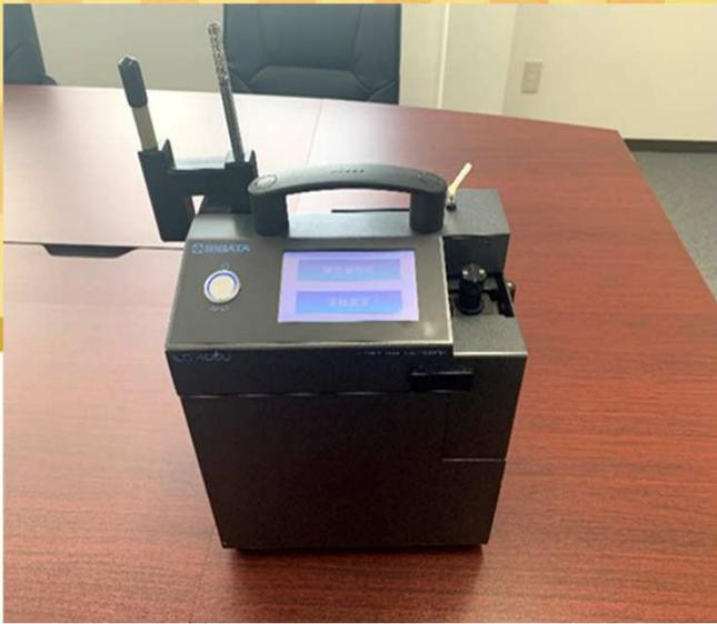
昔は項目ごとに計測機材があり、6項目すべてを計測するのも大変な作業でした今は左の写真のように、ボタン一つで6項目すべてを数分で計測できる機材があります。
